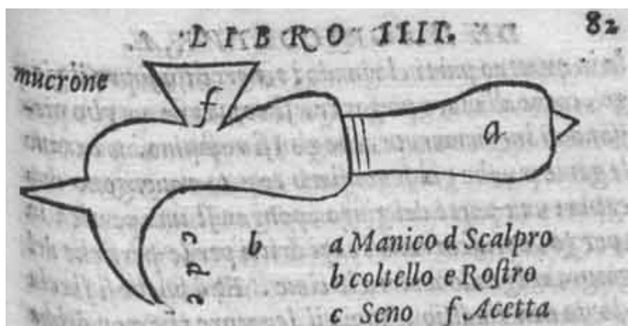
Figura 2 - Disegno esplicativo delle parti della roncola tratto dalla traduzione di De re rustica di Columella pubblicata da Niccolò Bevilacqua nel 1564 a Venezia, p. 82. https://preserver.beic.it/delivery/DeliveryManagerServlet?dps_pid=IE3786249
