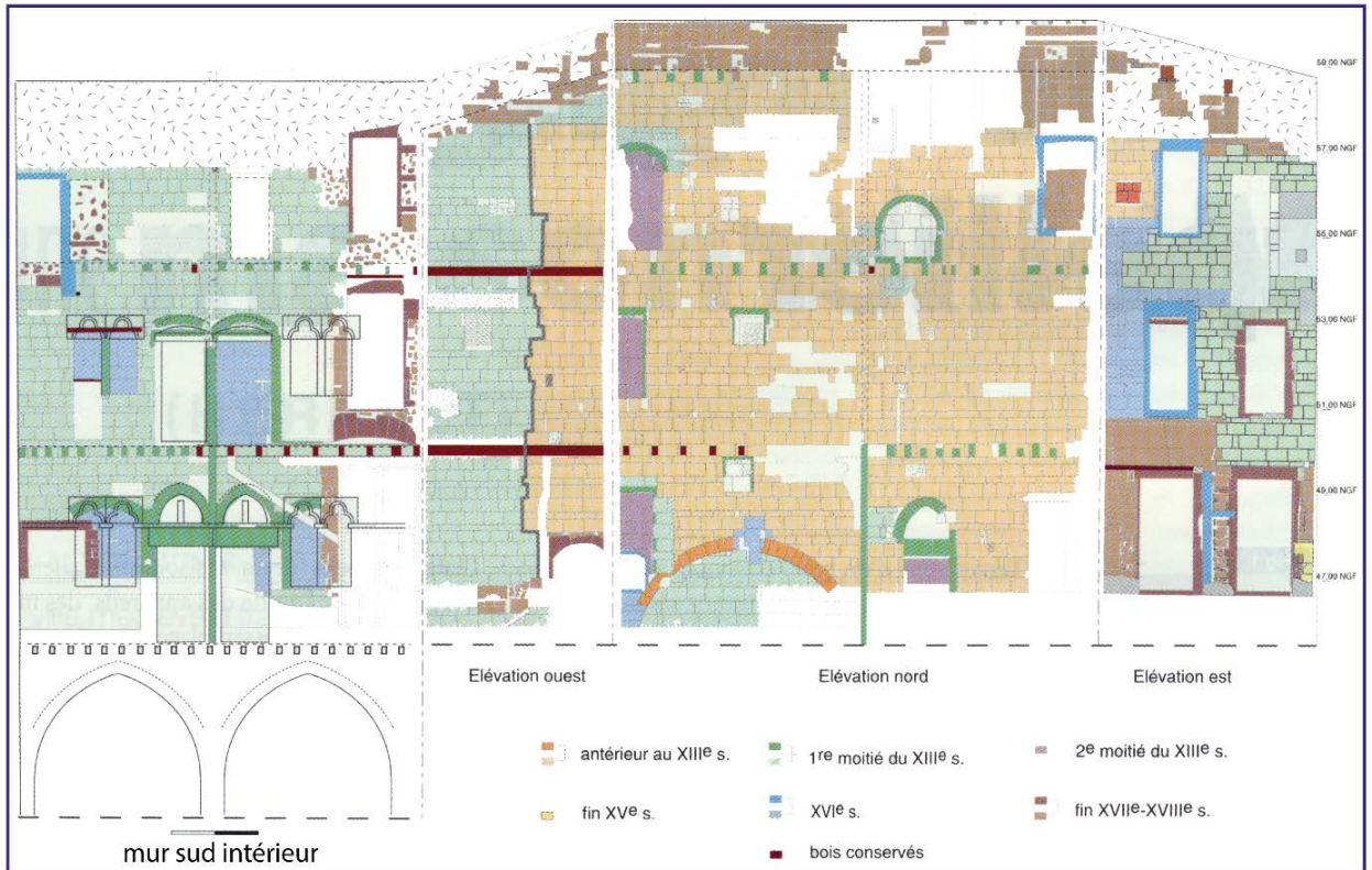
Relevés pierre à pierre des murs de la maison 1 de l'hôtel de Chirac, Montpellier
