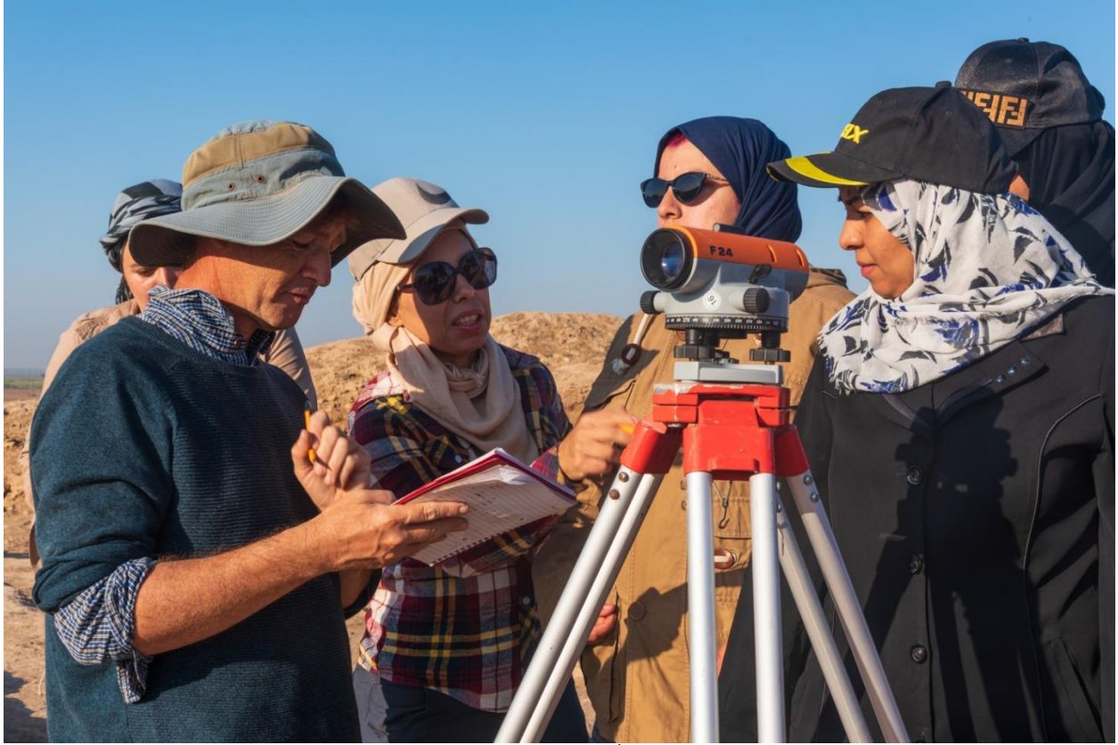
شكل 16.1 التهيئة لأخذ مناسيب بجهاز ضبط الاستواء
