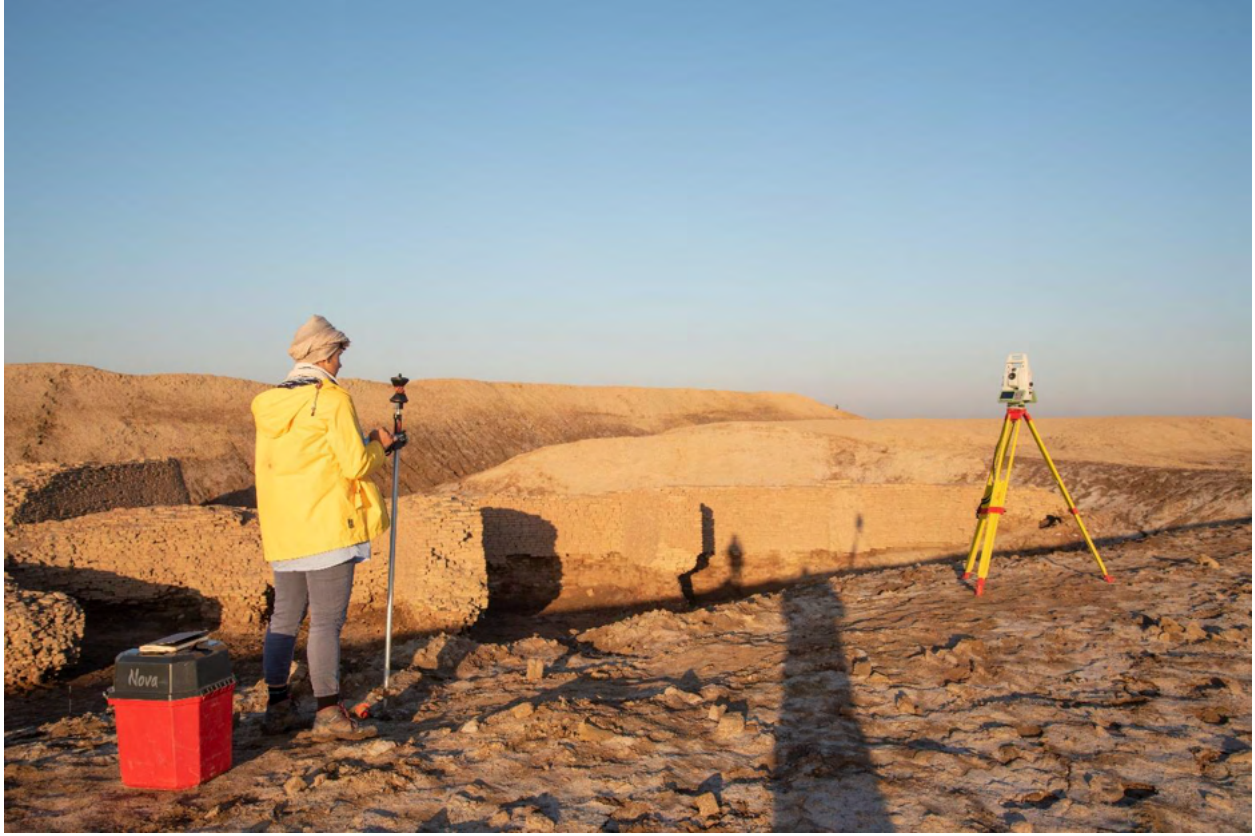
شكل 7.4 مسح يستخدم محطة متعددة بشخص واحد بالتحكم عن بعد
