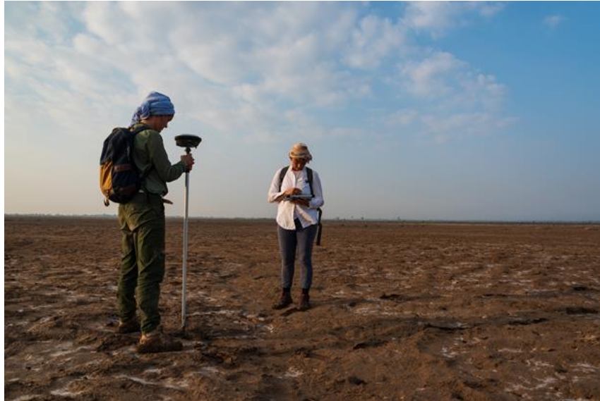
شكل 7.10 استخدام مستقبل (DGPS) (DNSS) مركبة على قطب
