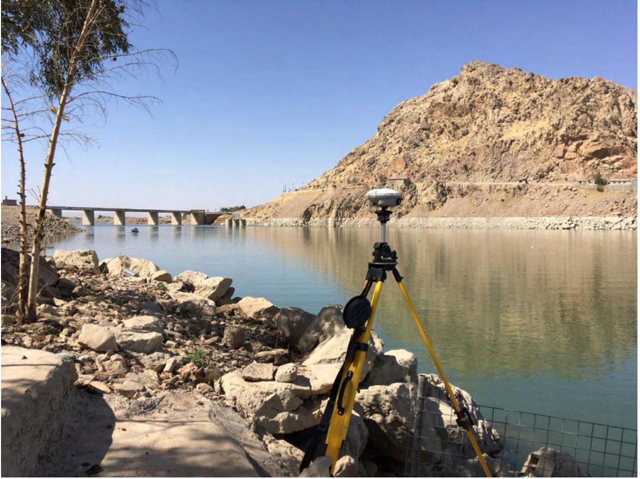
شكل 7.6 قياس نقطة ثابتة لنظام الملاحة عبر الأقمار الصناعية العالمي GNSS في Usu Aska
