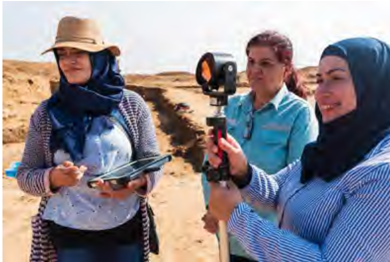
شیوهی ٣,٧ تیشکدەرەوه که له سەر لۆلهکێکی کانزایی باریکی شیوه خەری کەمێک درێژ دانراوه
