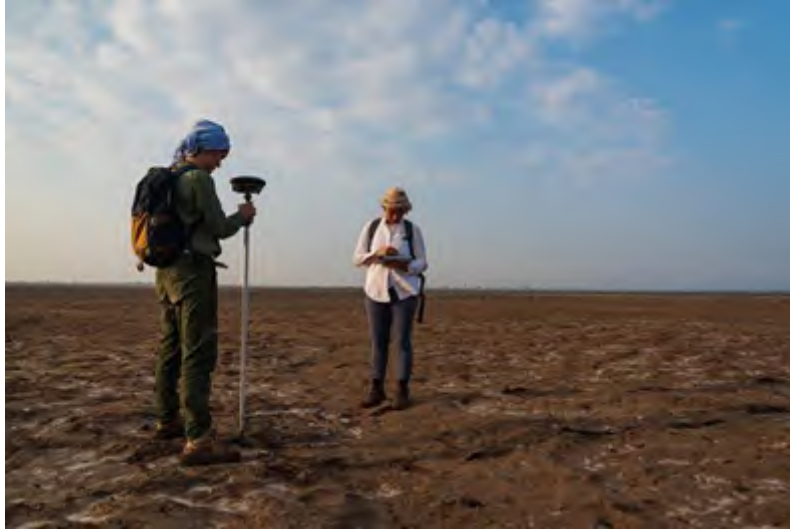
شېوهی ۱۰,۷ بهکارهینانی ریسپنسیو DGPS (DGPS) که لهسەر کوورته ستونیکي باریکی لولهیی کانزایی جیگیرکراوه (pole)
