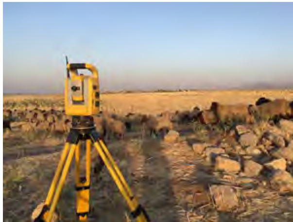
شیویه ۸،۷ راستکردنی ئامیره‌که له‌گه‌ل سیریکی دوردا (Aligning the instrument to a distant antenna)
