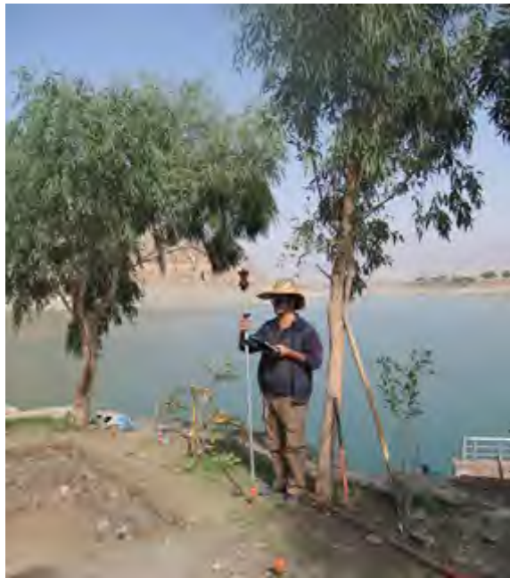
شیوه ی ۵،۷ گرتنی ستاف، لوله که کانزاییه باریکه شیوه خرکه که تیشکدهر هوه (staff with reflector) له سمر خالیکی
