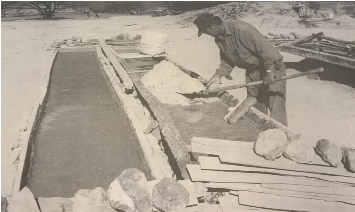
Figure 35: Canoa en bois utilisée dans la fabrication du sel sur le lac de Cuitzeo (d'après Williams, 2003: 130)
