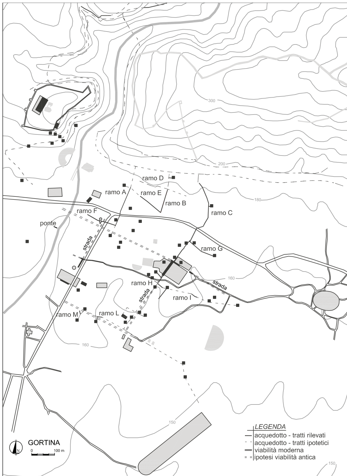
Figura 61. Pianta schematica della rete idrica in età romana e protobizantina in rapporto agli assi stradali noti della città antica (in tratteggio) e alla viabilità di età moderna.
