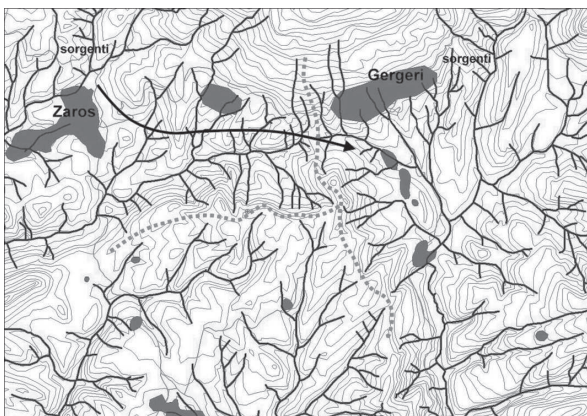
Figura 18. Planimetria schematica dell'assetto idrografico della zona: a tratteggio gli spartiacque naturali; la freccia indica il percorso ipotetico del nuovo acquedotto (da Arnoldus-Huyzendveld 2005).
