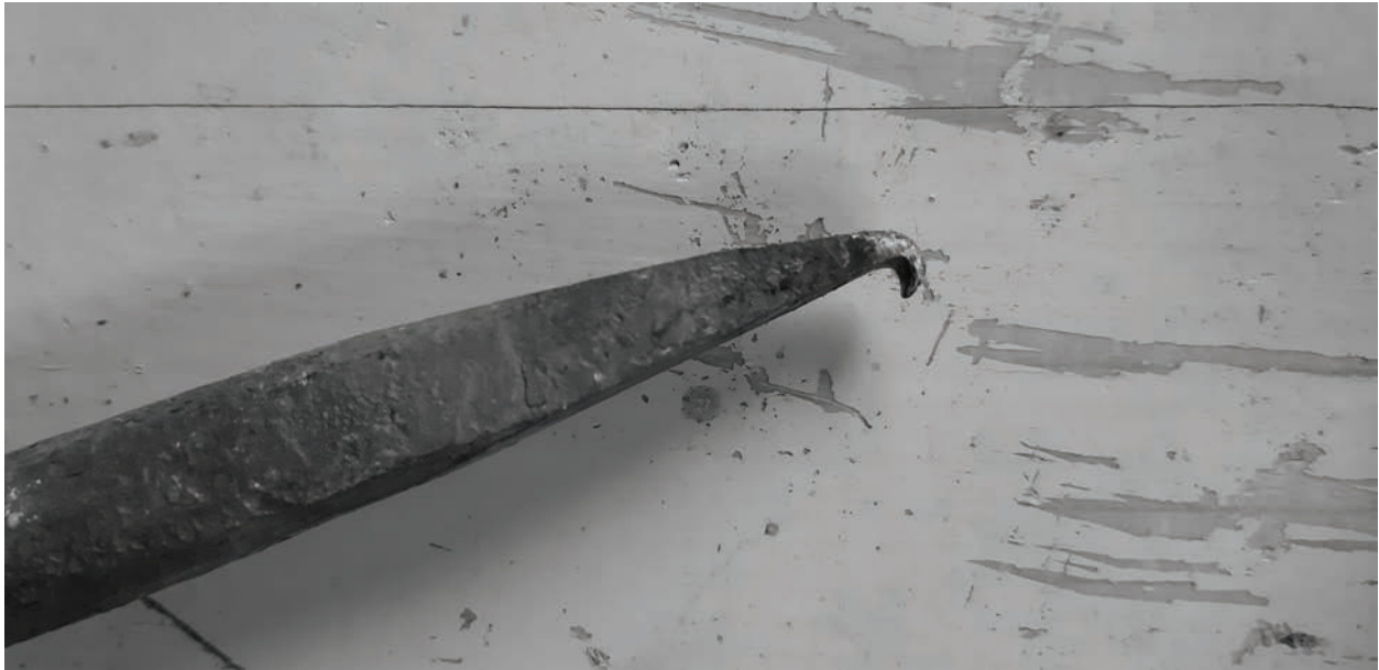
Figura 5. Esempio di punta in acciaio non temprata (equivalente al ferro dolce): al primo utilizzo la punta si deforma rendendola inservibile (foto dell'autore).
