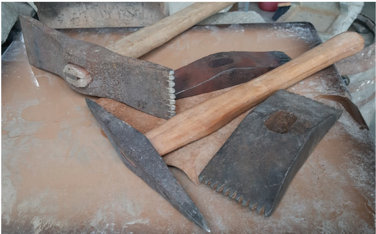
Figura 2. Martelline dentate e “picchiarello” (sorta di piccozza provvista di due punte alle estremità; foto dell'autore).
