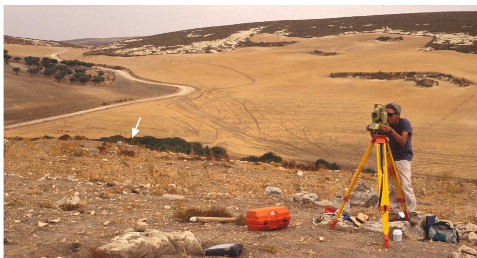
Figura 1.2. Aïn Wassel, rilevamento con stazione totale, Maura Medri. A sinistra: l'unico oliveto nella zona. Fondo: cima bianca del djebel Goudhane. In basso: oleandri sulle sponde dell'oued Aïn Wassel. La freccia indica l'abbondante sorgente, Aïn Wassel, ora captata in un abbeveratoio e da sempre sfruttata dalla popolazione e dagli animali della zona rurale. Foto P. Chistè 1994.
