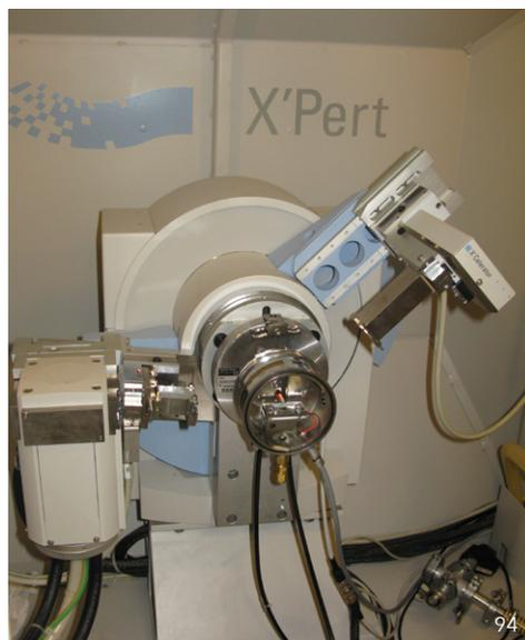
(0,04 rd), porte-échantillon fixe (*flatstage*) et filtre Ni. Le détecteur Xccelerator est de type détecteur solide permettant l'acquisition simultanée sur un secteur angulaire de  $2^\circ 2q$  Fig. 94.
