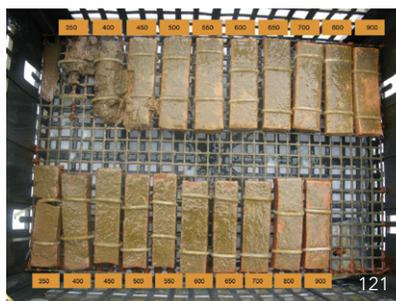
Test de dégradation des argiles en milieu lacustre. Dans la caisse sont disposées 2 rangées d'éprouvettes. En haut: argile d'Alex. En bas: argile de Saint-Jorioz. De gauche à droite et de haut en bas, on peut suivre l'évolution mois après mois.
