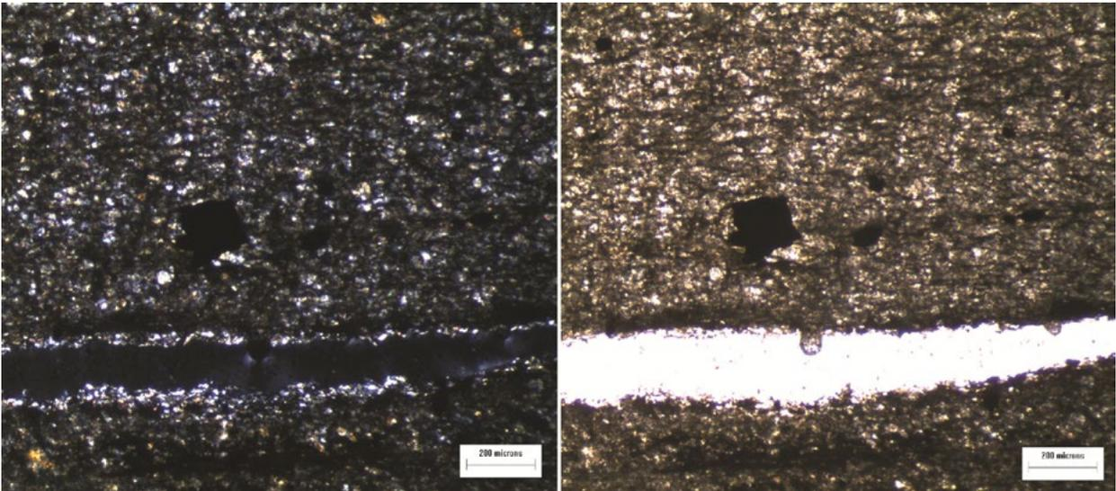
FIGURA PP-2. MINERALES ALINEADOS FLUIDAMENTE. A LA IZQUIERDA FOTOGRAFÍA TOMADA CON ANALIZADOR, A LA DERECHA SIN EL MISMO.
